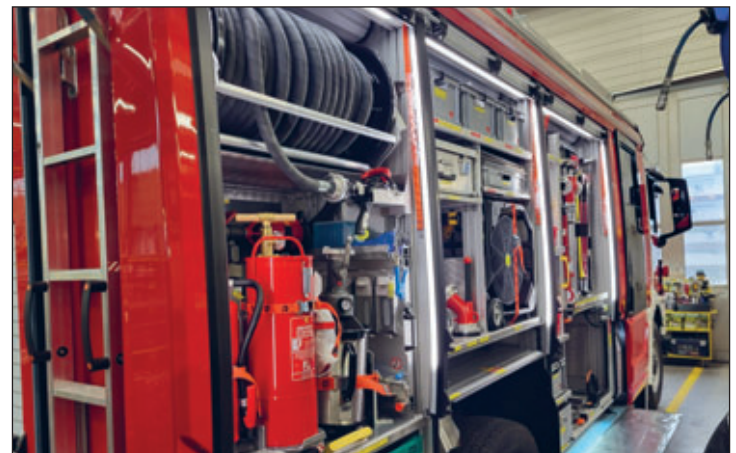
Gut zu sehen: Die Schnellangriffsleitung und Hochleistungslüfter auf Elektrobasis.
