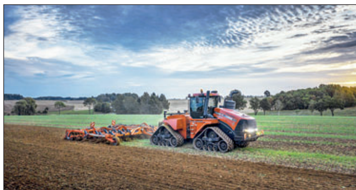
Einsatz von Raupenfahrwerken bei Agraset Pluspunkte: maximale Bodenschonung, maximale Dieseleffizienz, sehr hohe Zugleistung bei minimalem Schlupf
