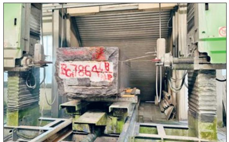
Mit dieser Maschine werden die Blöcke geschnitten.
